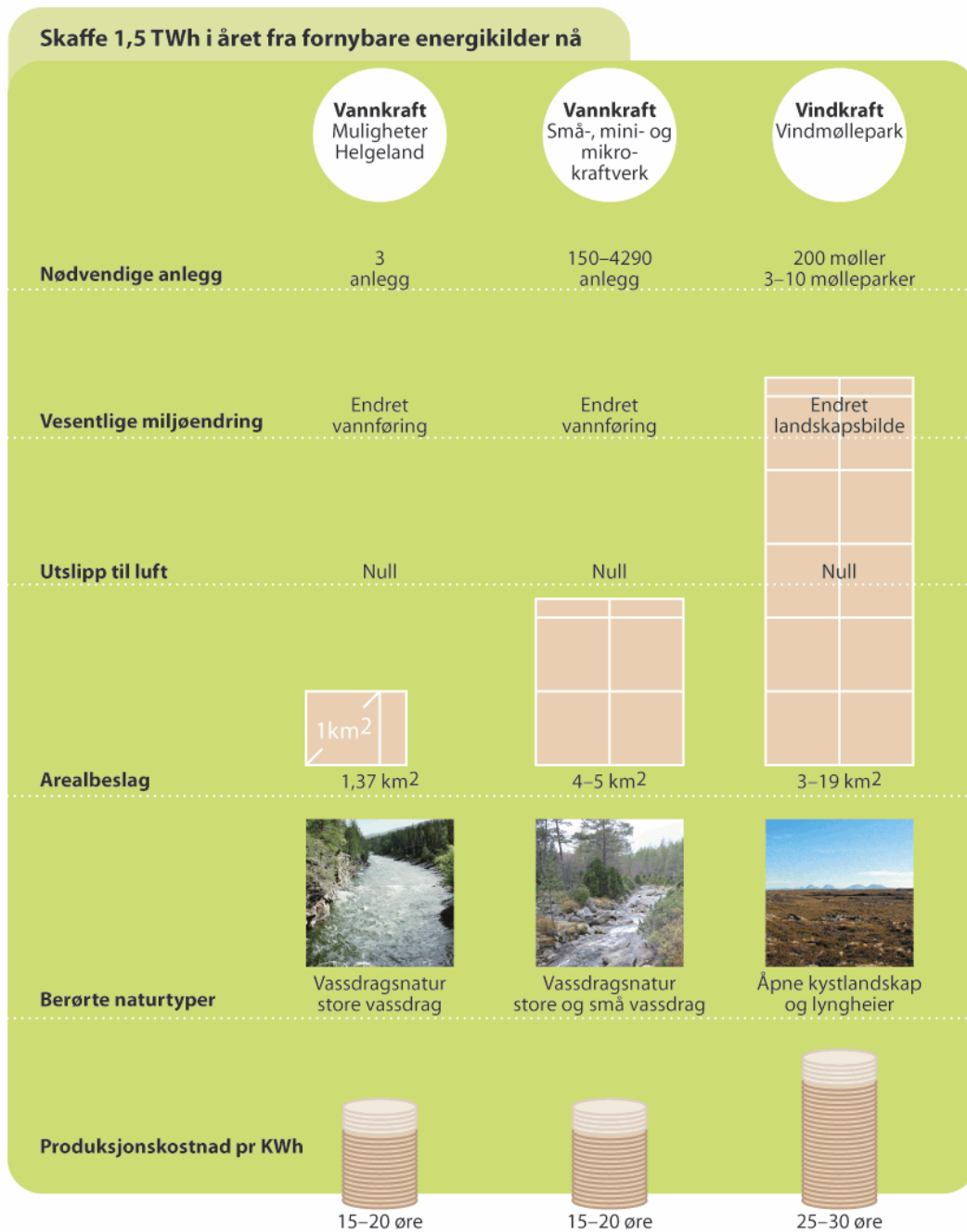
Sammenligning av miljøpåvirkning ved produksjon av 1,5 TWh elektrisitet ved vindgenerator, småkraft og større moderne vannkraftprosjekter ved utnyttelse av eksisterende magasiner. Kilde: Civitas, NVE, Statkraft, mfl.
