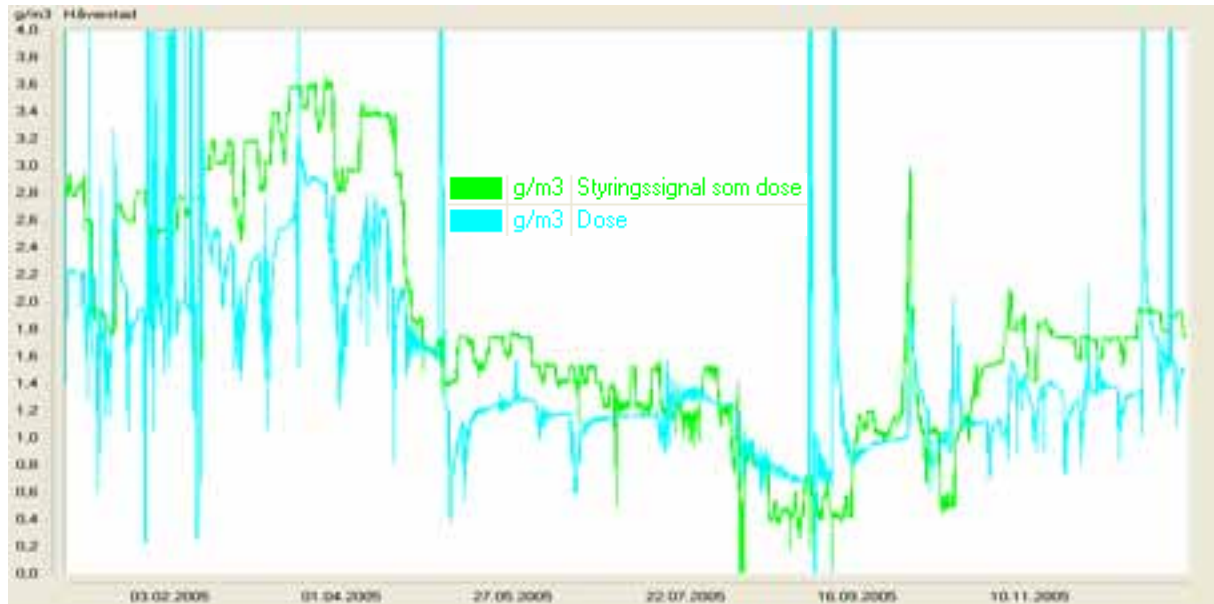
Figur 4. Styringssignal som dose og den reelle dosen fra Håverstad doseringsanlegg i 2005. Figuren viser stor variasjon i dosene over året. Årsaken til at registrert dose gjør store hopp i kurven er at små svikt i vektregistreringene forstyrrer beregningsgrunnlaget for utregning av dose. Utregnet dose er mest eksakt i fyllingsøyeblikket for ny kalkforsyning (Høgberget og Hindar 1998).
