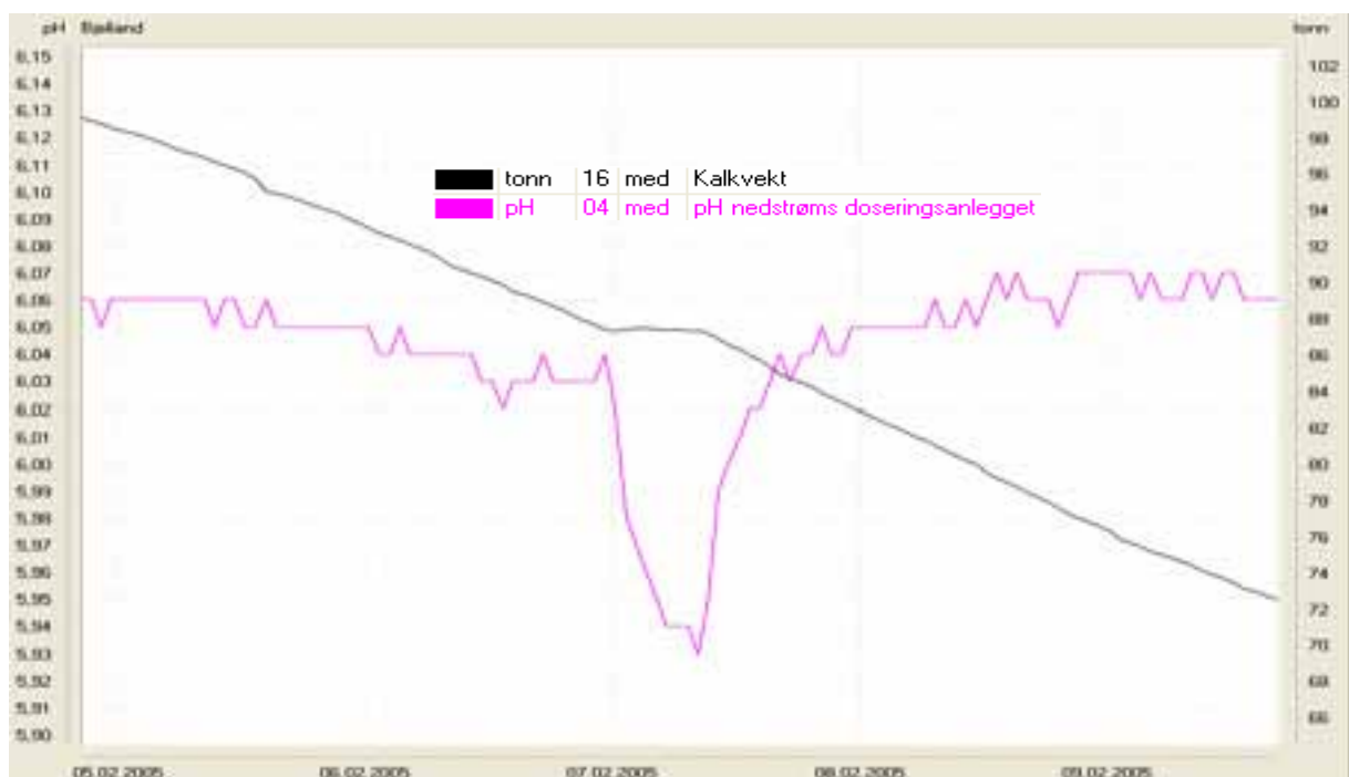
Figur 5. Kalkvekt og pH nedstrøms Bjelland doseringsanlegg februar 2005. Stopp i doseringen fra anlegget førte til pH-verdier under målet for lakseførende strekning. Imidlertid var episoden meget kortvarig. pH var også minimalt under pH-målet på 6,0. Derfor antas episoden ikke å ha hatt noen innvirkning på de biologiske forholdene i elva.
