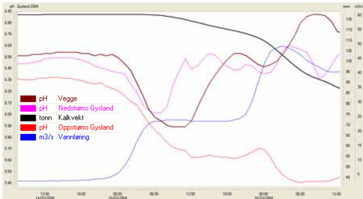
Figur 5. Nytt eksempel på episode (15. mars 2004) hvor anlegget ikke reagerer raskt nok til å unngå pH-dropp på Vegge. Noe av problemet skyldes at pH nedstrøms Gysland ikke fungerer godt nok som styringssignal (pH-dropper 0,3 tideler før doseringen fra anlegget trappes opp). pH-mål i elva er 6,2 på denne tiden.
