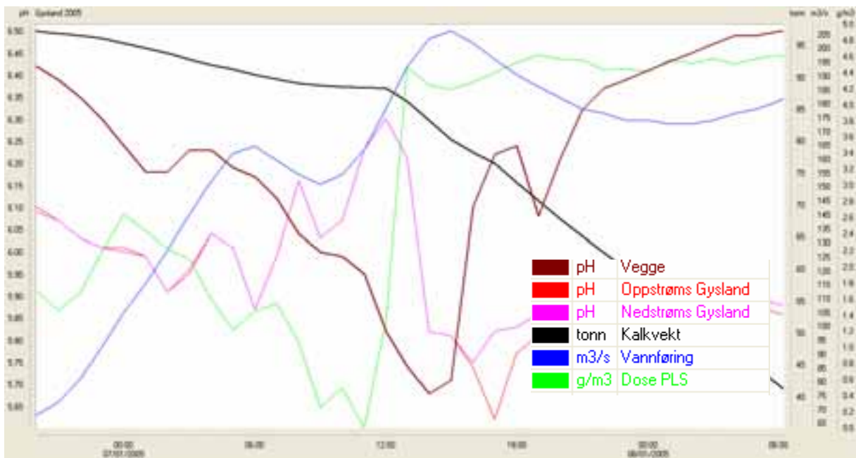
Figur 7. Manglende vanngjennomstrømning i kyvette nedstrøms Gysland fører til feil pH og for lav dose under kraftig flom 7. januar 2005. Overstyring av pH ble igangsatt, men det var likevel for sent i forhold til å unngå pH-dropp på Vegge.
