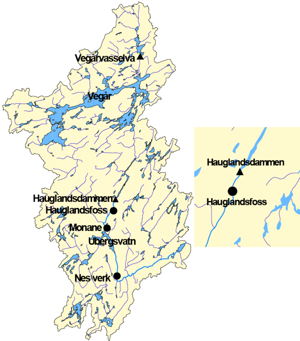
Figur 1. Storelva med nedbørfelt (457 km 2 ), plassering av kalkdoseringsanlegg (trekanter) og pH-målestasjoner (sirkler). Kalkdosereren i Vegårvasselva er ikke lenger operativ.
