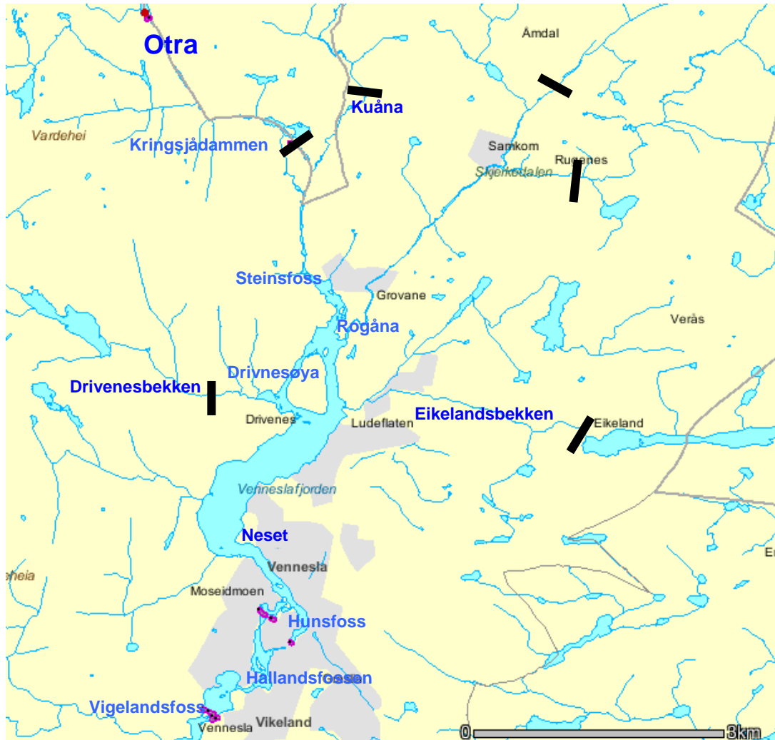
Figur 4. Kart over Venneslafjorden fra Vigelandsfossen i sør til Kringsjødammen og Kuåna i nord. De mørke tverrstrekene på tvers av bekkeløpene angir hinder og potensielle hinder for fiskevandring.
