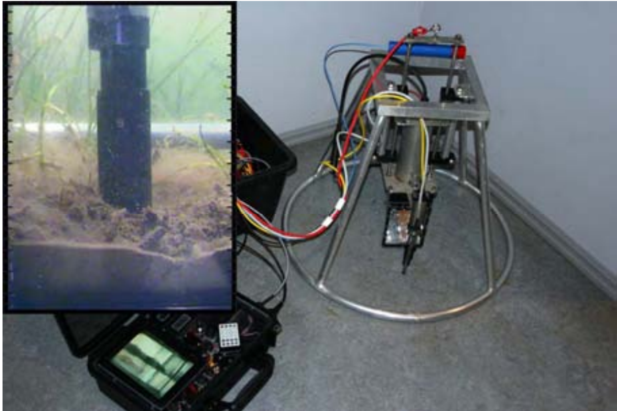
Figur 2. eSPI utstyr (Kamerarigg med elektroder og kontrollenhet med skjerm). Et eSPI bilde er innsatt i øvre venstre hjørne.
