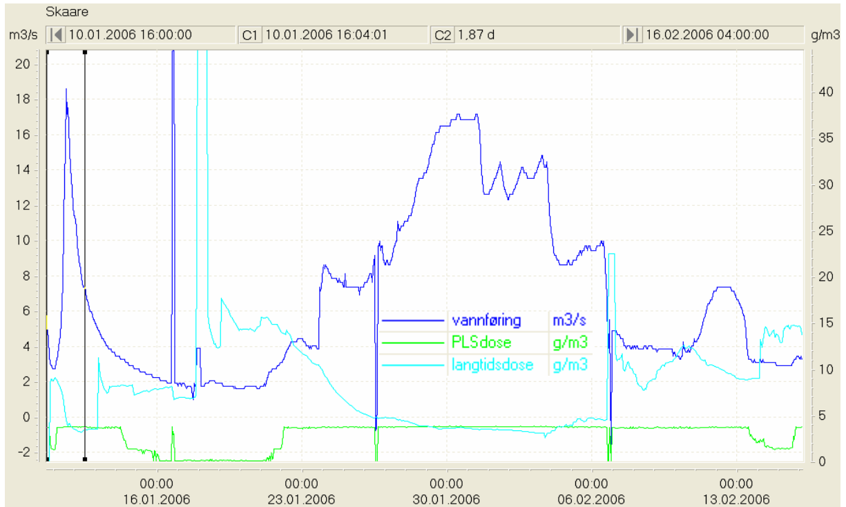
Figur 12. Vannføring, styringsdose og langtidsdose på Skåre doseringsanlegg i deler av januar og februar 2006. Figuren viser ingen sammenheng mellom styringsdose og faktisk dose. Imidlertid ble identiske avlesningsverdier da Hovlandsåna gikk i flom.
