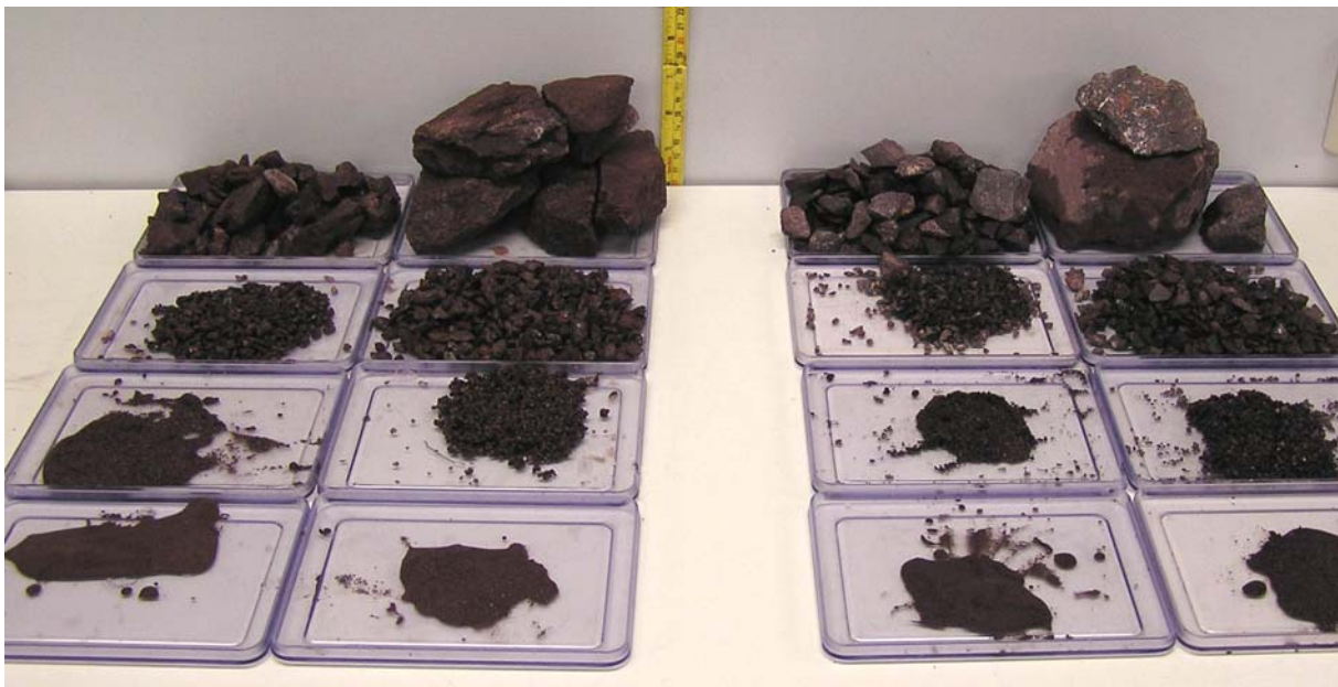
Figur 11. Sammensetning av partikkelstørrelser av sprengstein i test fra tunnelen hentet fra to steder i forfylling.
