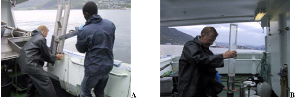
Figur 3. Innsamling av sedimenter. A: Dobbelt Gemini kjerneprøvetaker. B: Kjerneprøven gjøres klar for snitting.
