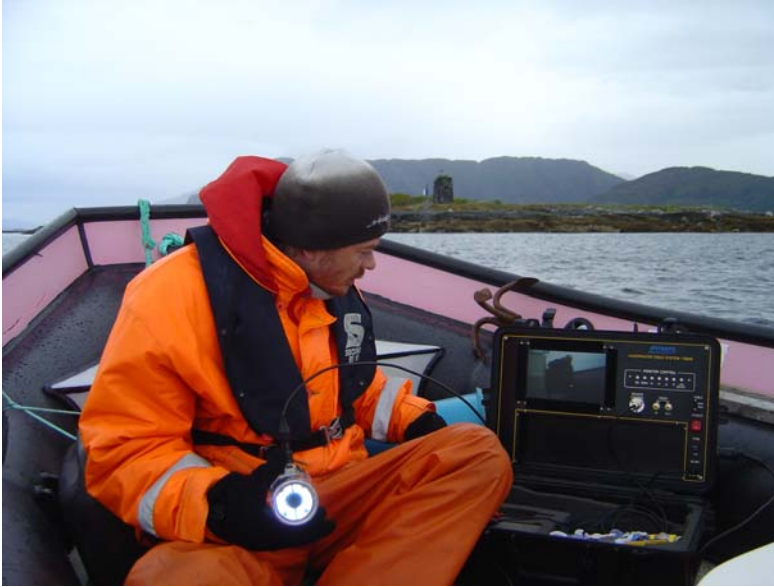
Fig. 2. Data ble samlet inn med bruk av drop-kamera. Fysiske og topografiske bunnforhold og arter (makroalger og kråkeboller) ble registrert sammen med geografisk posisjon (Foto: H Christie).
