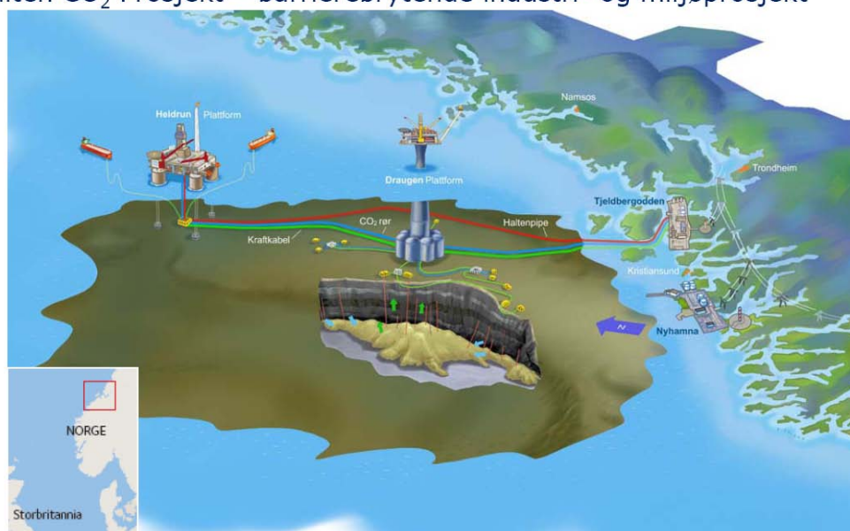
Figur 28. Skisse av prosjektet for injeksjon på Haltenbanken (Draugen) av CO 2 frå gasskraftverket på Tjeldbergodden. (Figur: Statoil/Shell).
