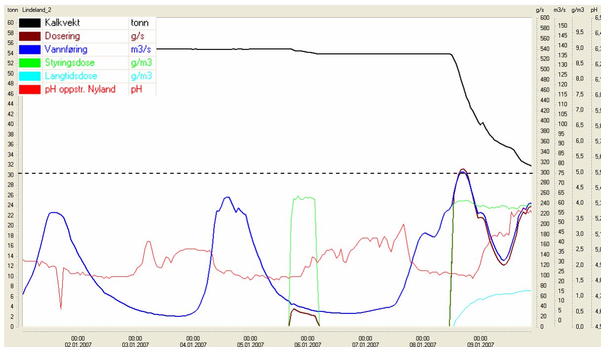
Figur 5. Manglende dosering ved varierende vannføring i begynnelsen av januar fører lav pH ned mot Nyland. Det er usikkert hvorfor styringssignalet har falt bort i den aktuelle perioden. pH-målet på 5,5 oppstrøms Nyland er vist med stiplede linje.
