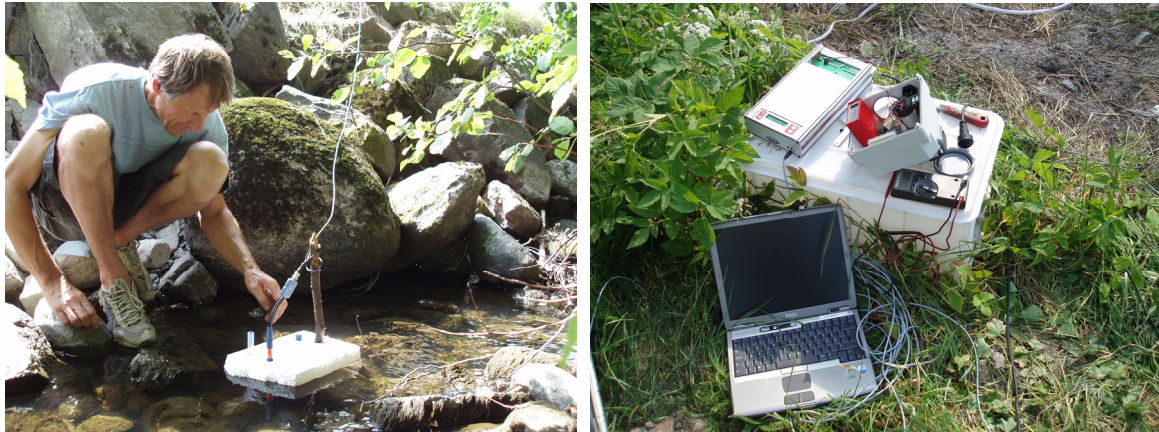
Figur 1. Bilder av pH-målingsutstyret. pH-elektroden og forsterkeren ble montert på en enkel flottør av isopor. Nødvendig utstyr for å kunne sette opp pH-reguleringsforsøket var pc, logger, pumpe og regulator.
