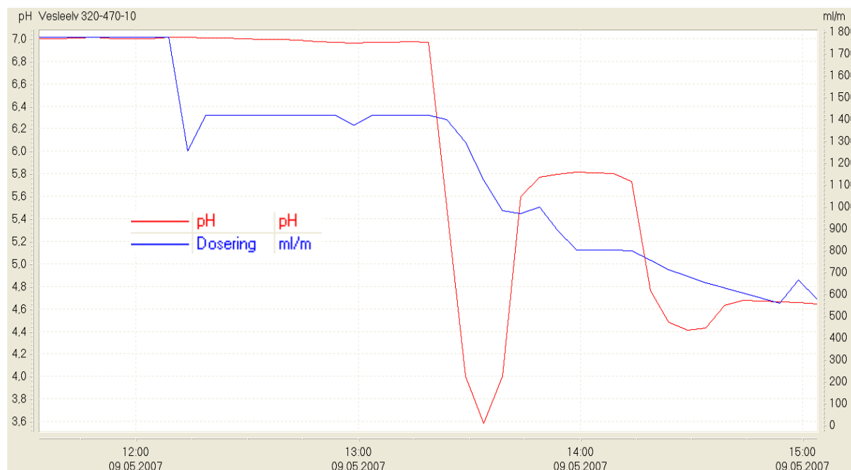
Figur 13. Doseringsnivå og pH nedstrøms doseringspunktet i Vesleelv gjennom første del av forsøket våren 2007. Doseringskapasitet og reguleringsinnstillinger passet dårlig overens, og det ble vedvarende surt vann nedstrøms doseringen i lang tid.
