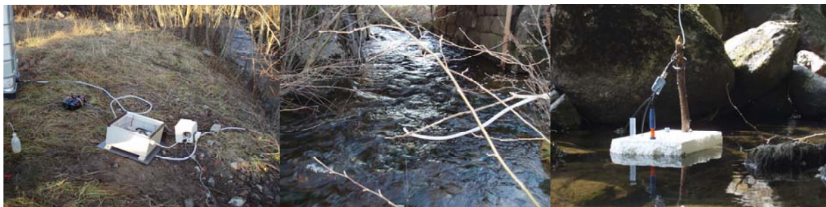
Figur 4. Forsøkene i Tollerudbekken høsten 2006 med doseringsutstyr, doseringspunkt og pH-flottør.
