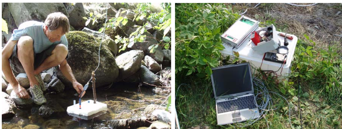
Figur 1. Bilder av pH-målingsutstyret. pH-elektroden og forsterkeren ble montert på en enkel flottør av isopor. Nødvendig utstyr for å kunne sette opp pH-reguleringsforsøket var pc, logger, pumpe og regulator.
