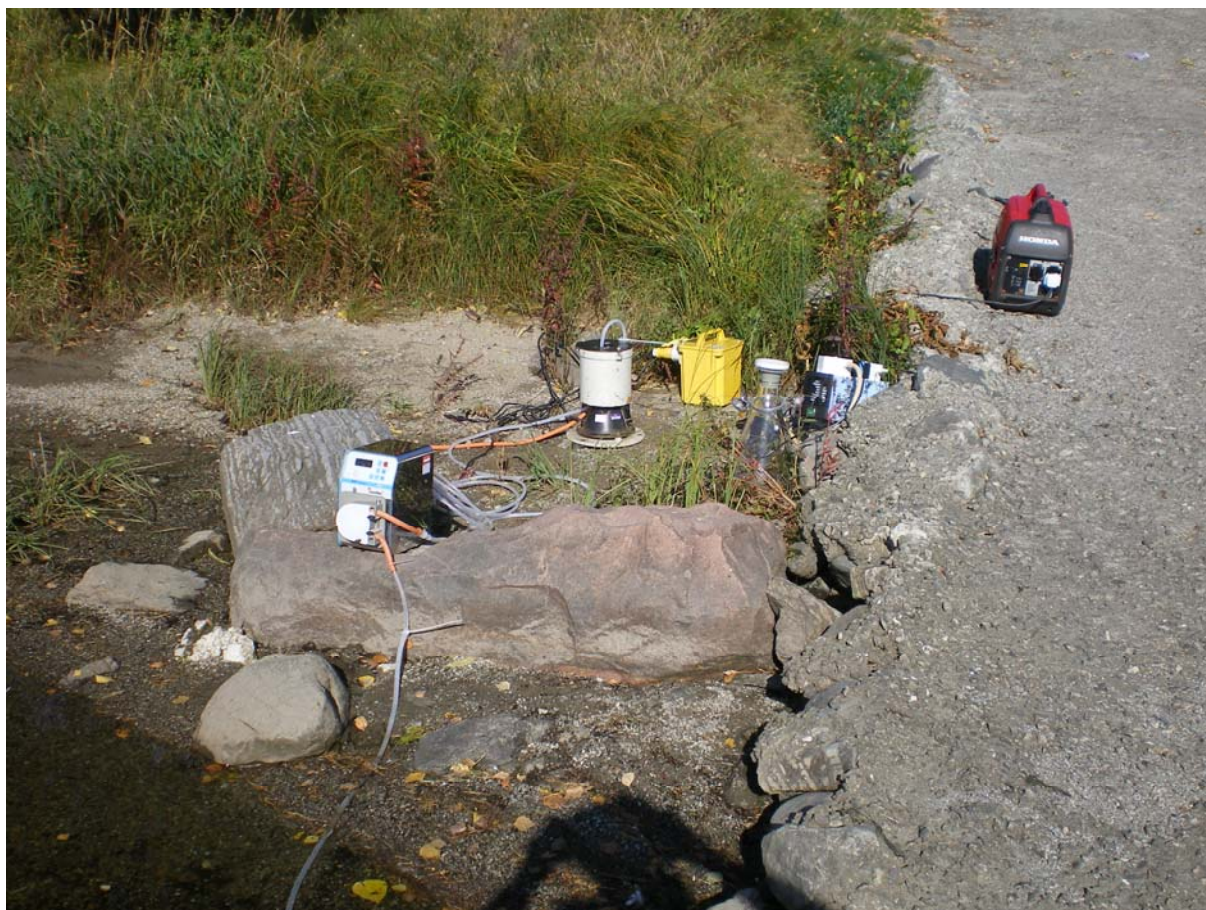
Bilde 4. Kontinuerlig vannstrømsentrifuge benyttet i Alna og Akerselva.
