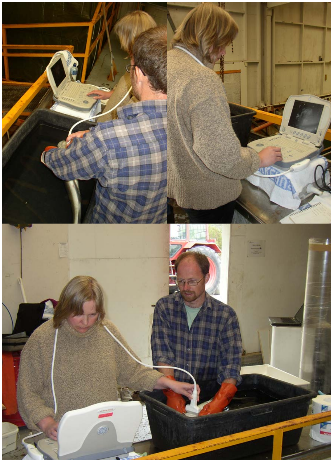
Figur 4. Ultralydmålinger. Den bedøvede fisken holdes med buksiden opp i vann med vedlikeholdsdose av bedøvelse (metomidat).
