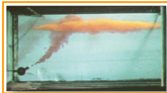
Figur 21. Foto frå laboratorieforsøk med farga oppstigande (lett, ferskt) vatn i ei sjikta væske (sjøvatn).
