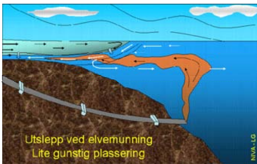
Figur 4. Illustrasjon av utslepp nær ei elvemunning, der kompensasjonsstraumen fører fortynta avlaupsvatt innover (ugunstig arrangement).
