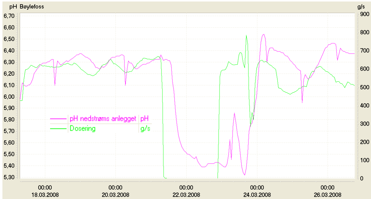
Figur 4. pH nedstrøms anlegget (Evenstad) og doseringen fra Bøylefossanlegget i mars 2008. Anlegget mistet nettstrømmen i lang tid på grunn av uvær. Langvarig stort pH-dropp ble registrert. Vannkvaliteten ble da for dårlig for laks, sannsynligvis ble laksebestanden skadet.
