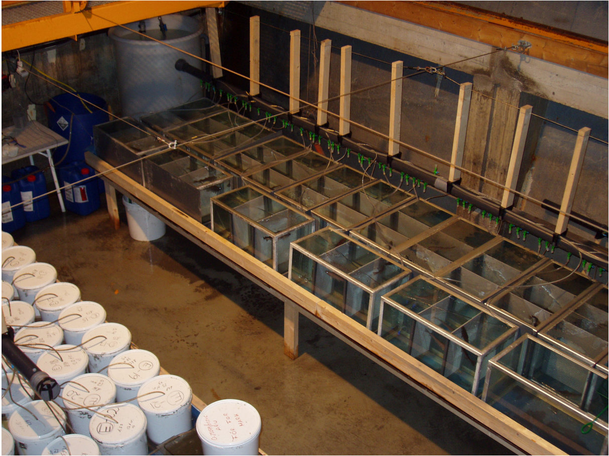
Figur 6. Fotografi av deler av eksponeringsoppsettet. Beholdere med flerbørstemark ( Nereis virens ) til venstre, og torsk i akvarier (m/adskilte rom), klare til å bli fôret med flerbørstemark til høyre.
