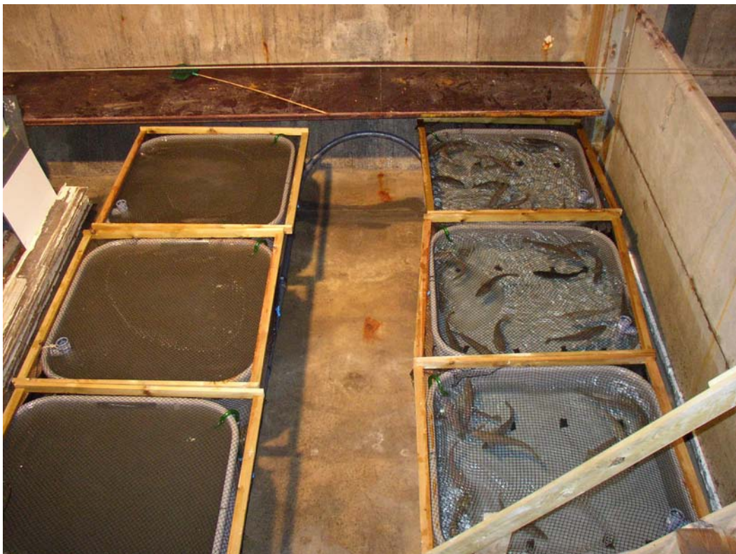
Figur 4. Fotografi av forsøksoppsettet (”oppvirvlingsforsøket”). Eksponert gruppe, med sediment i karene til venstre og kontrollgruppe til høyre. Ved hvert prøveuttak ble en fisk fra hvert kar tatt ut (altså 3 replikater i hver gruppe).
