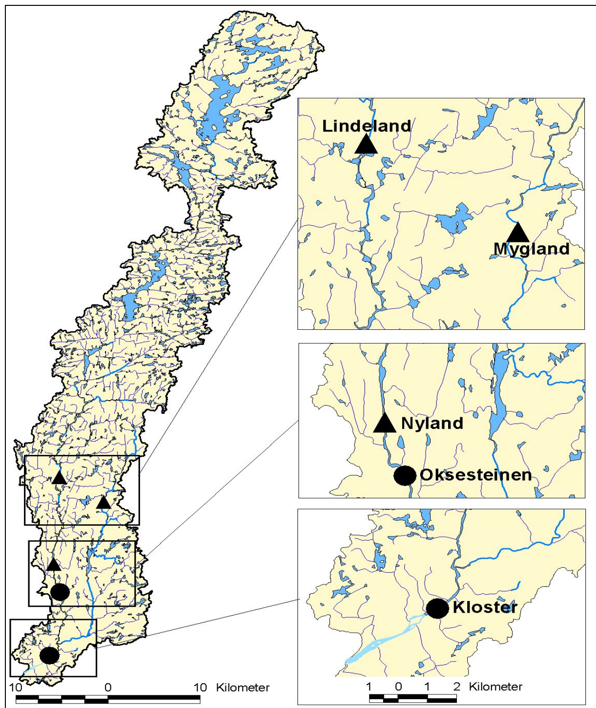
Figur 1. Kart over nedbørfeltet til Kvina med utsnitt av tre områder i stor målestokk som viser plasseringen av kalkdoserere (triangler) og pH-målestasjoner (sirkler).
