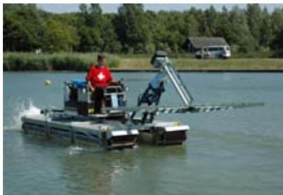
2. Amfibietraktoren "Truxdor" påmontert klipper 3090.
