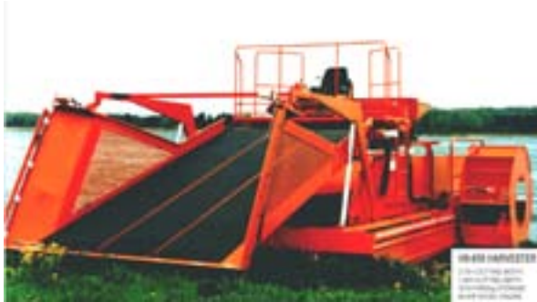
1. Høstingsmaskin fra Aquamarine USA. Skjærebordet består av to vertikale og en horisontal slåmaskinkniv. Plantene transporteres opp av vannet ved et netting-transportbånd. Fremdriften er skovlejhjul.
