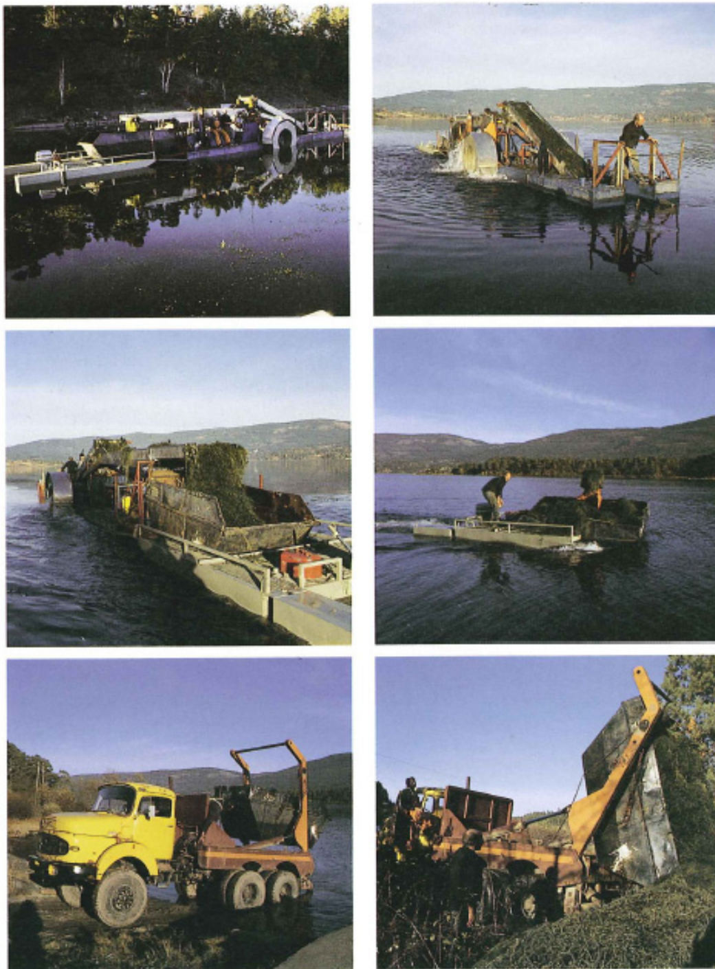
Figur 27. Vasspesthøsting i Steinsfjorden med maskinen "Slurpen". Skjærehodet består av to vertikale og en horisontal slåmaskinkniv. Et transportbånd av netting fører vegetasjonen opp av vannet, over båten og ned i en container som henger bak. En "supply-båt" kan henge på en ny container og transportere den høstede vegetasjonen til land der det hentes av en bil med container-lift. Maskinen kan høste kontinuerlig uten å måtte avbryte arbeidet for å transportere plantemateriale til land. Foto: Dag Berge.
