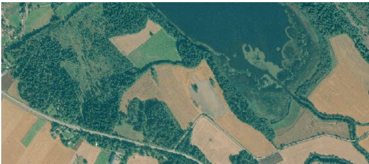
Figur 32. Tilførselene fra jordbruksarealer går ofte i egne grøfter og bekker som lager kanaler gjennom vegetasjonsbeltene, slik at det ikke skjer noen effektiv infiltrasjon. Bildet viser Haugestadvannet i Vestfold (flybilde fra Hof kommunes hjemmesider).
