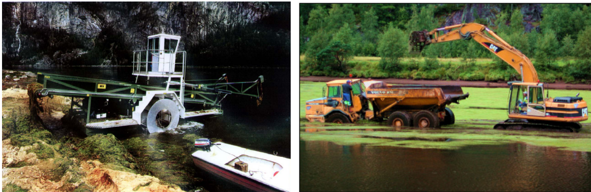
Figur 29. Venstre: En Watermaster RS 2000 (finsk-produsert) ble benyttet av Krypsivprosjektet i 1996. Høyre: Gravemaskin er også benyttet for å ta opp krypsiv. Fotos: B. Rørslett (venstre bilde) og http://vestagder.miljostatus.no (høyre bilde).
