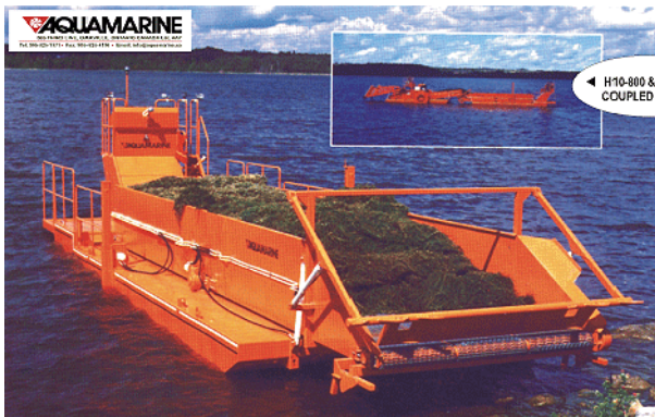
3. Det leveres også en egen selvgående lekter for ilandkjøring av det høstede materialet. Legg merke til at lekteren er koplet til høstemaskinen i det innfelte bildet. Bunnen av høstemaskinen og lekteren er utstyrt med transportbånd, slik at lasting og lossing går raskt.
