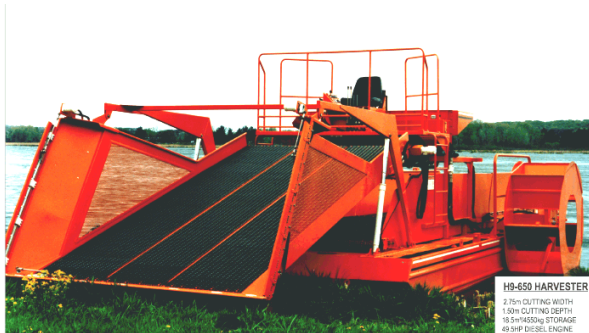
1. Høstingsmaskin fra Aquamarine USA. Skjærebordet består av to vertikale og en horisontal slåmaskinkniv. Plantene transporteres opp av vannet ved et netting-transportbånd. Fremdriften er skovlethjul.
