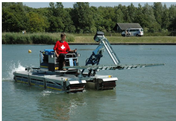
2. Amfibietraktoren "Truxdor" påmontert klipper 3090.
