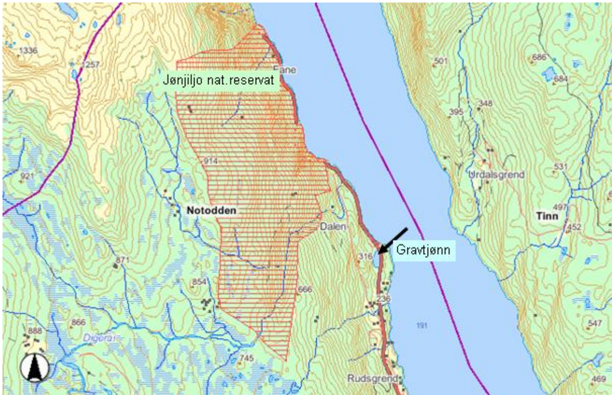
Figur 2. Jønjliljo naturreservat ligger nord i Notodden kommune, i skrentene på vestsiden av Tinnsjø. RV 37 går i tunnel gjennom deler av det vernede området. Grøvtjønn er det tjernet langs trasseen der påvirkning av veisalting er mest sannsynlig. Se for øvrig tekst.
