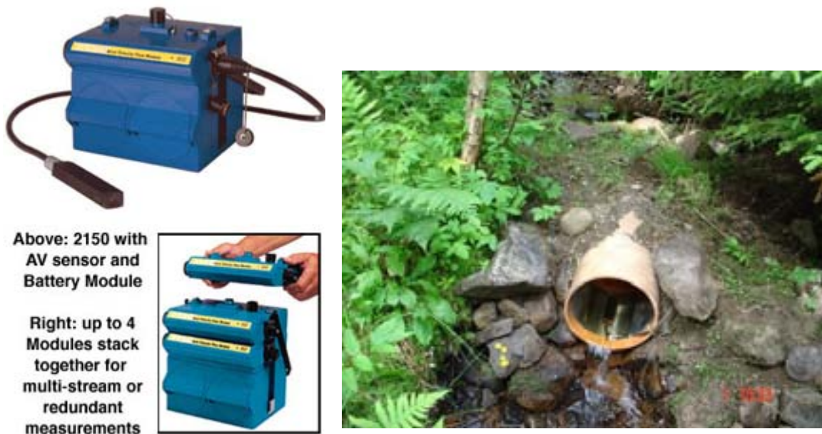
Figur 5. Registreringsenheten som settes på land ved bekken. Sensoren monteres i bakkant av røret. Bildet er tatt ved spesielt lav vannføring i bekken som avvanner Styrvoll skytebane
