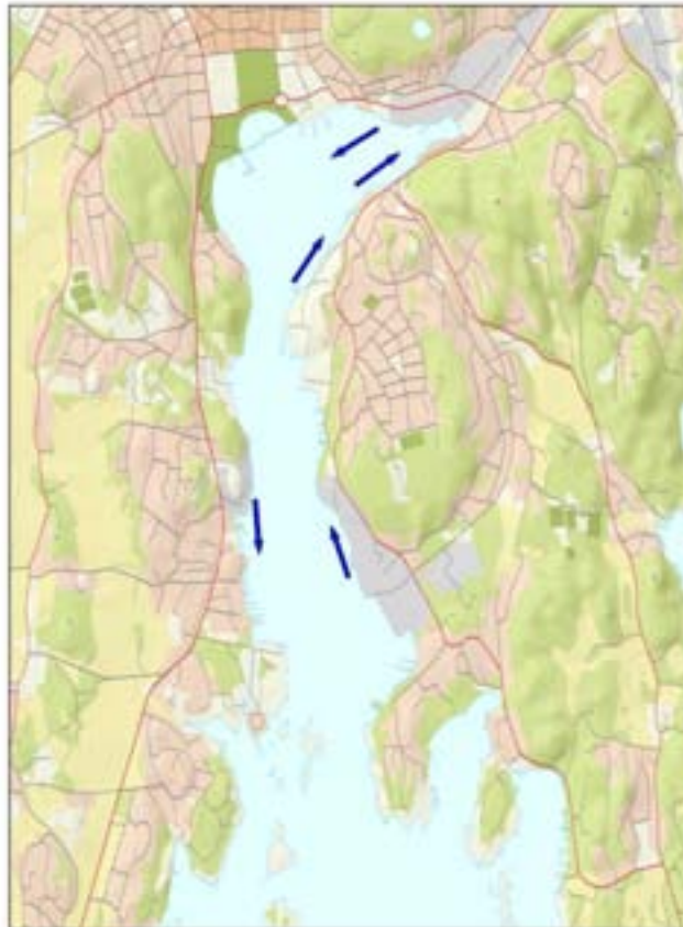
Figur 7. Skjematisk skisse av kjent sirkulasjonsmønster i Sandefjordsfjorden ut fra de gjennomførte strømmålingene. Sentrum av pilene angir posisjon for måleriggene.
