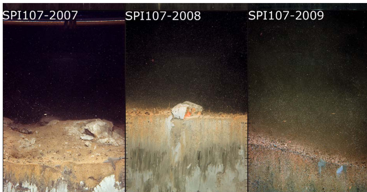
Figur 10. Sedimentprofilbilde fra indre Oslo havn. Bildene fra stasjon SPI107 utenfor Aker brygge fra 2007 til 2009. SPI-bildene viser en forandring mellom årene etter at bunnfauna har bioturbert sedimentene som ble tildekket med leire fra senketunnelen. Dekkmassene syns som svære klumper på og under sedimentoverflaten i bildet fra 2007, mens en i 2009 ser at sedimentet er overdekket med sand.
