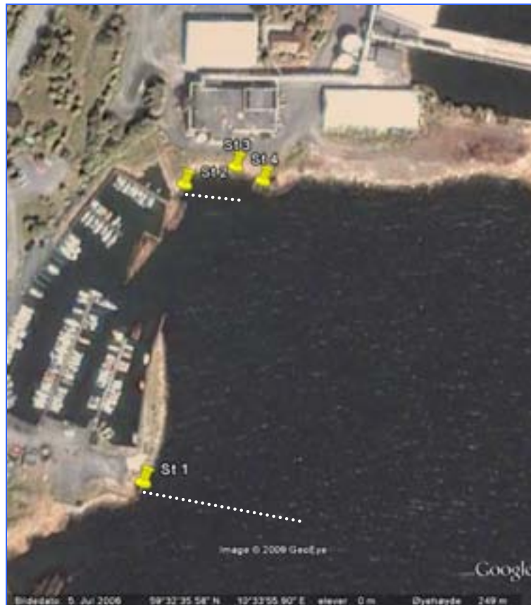
Figur 1. Plassering av de 4 stasjonene utenfor Statkrafts saltkraftanlegg på Hurum. De prikkete hvite linjene indikerer transektene hvor dykkeregistrering ble gjennomført. Utslippspunktet ligger omtrent ved enden av transektet på stasjon 2.
