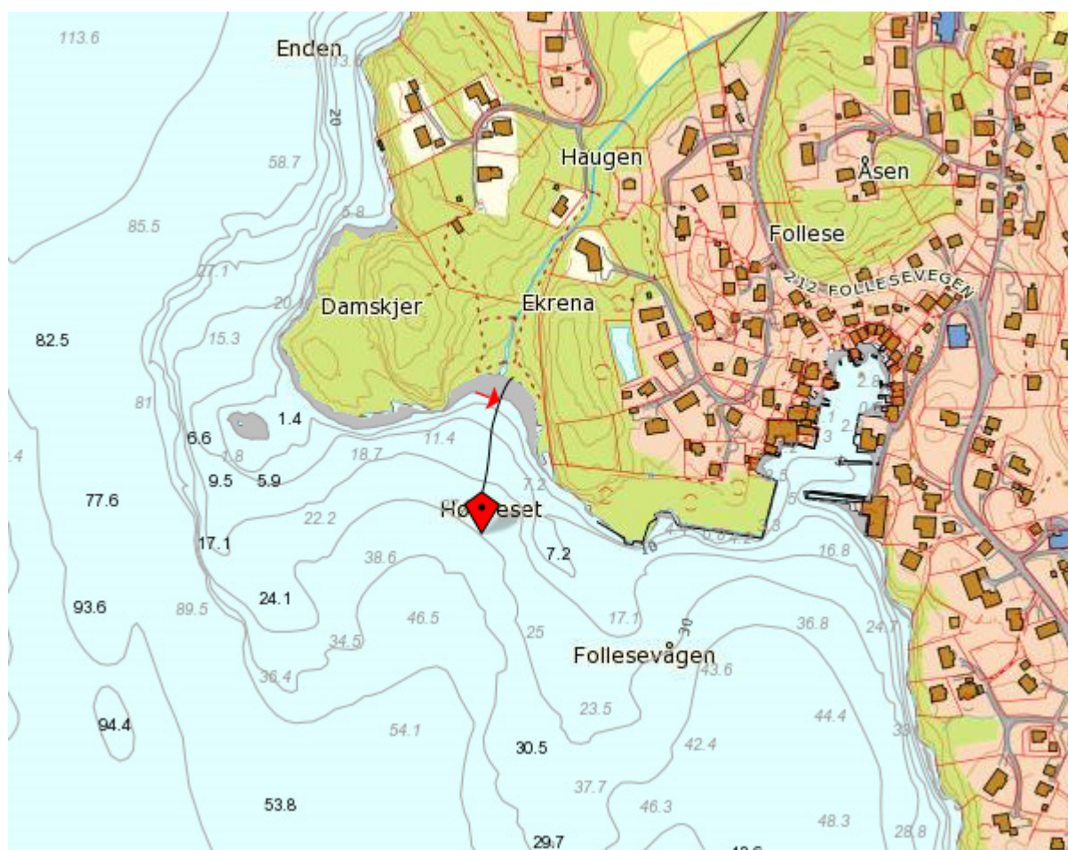
Figur 7. Haugadalen (Follese). Rød firkant markerer utslippspunkt for kommunal avløpsledning. Rød pil markerer observert bruddsted for avløpsledningen.
