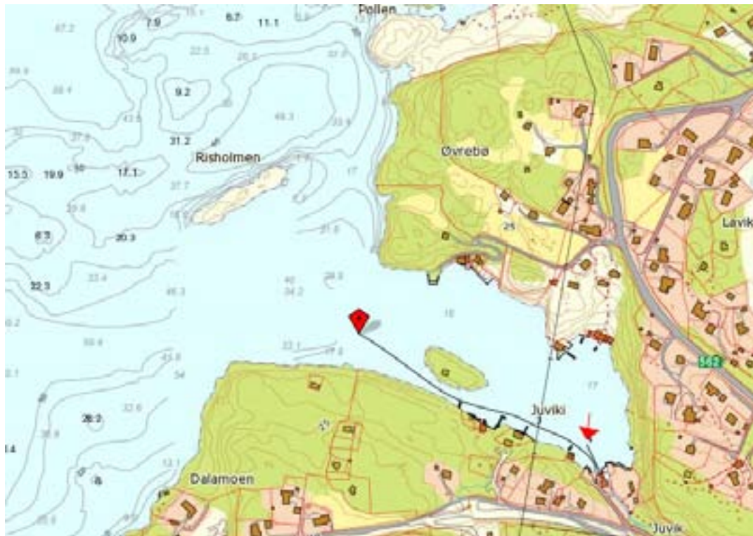
Figur 5. Juvik. Rød firkant markerer utslippspunkt for kommunal avløpsledning, mens rød pil markerer overløpets endepunkt.
