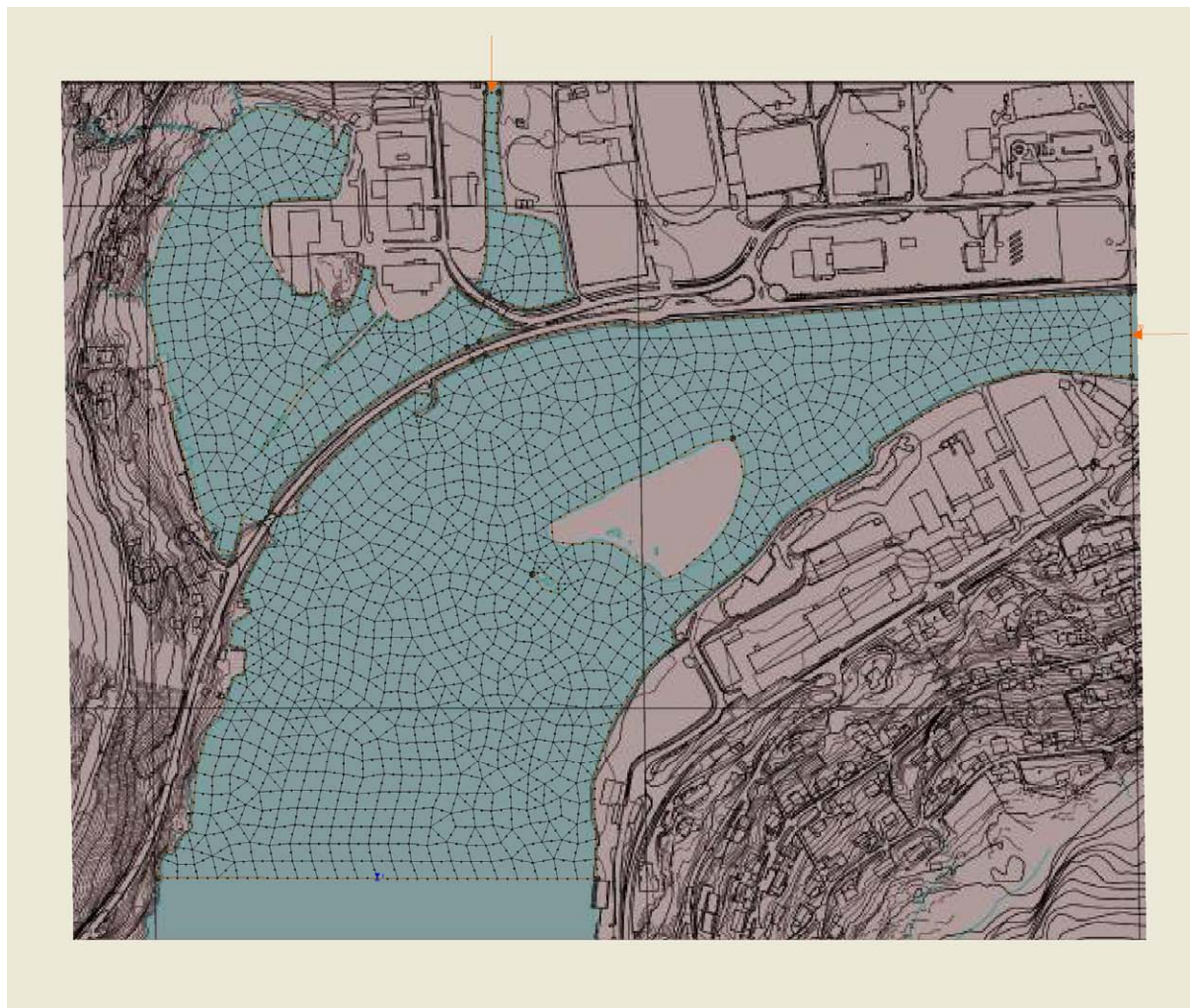
Figur 3. Nettverket eller gridet i RMA2-modellen for simulering av sirkulasjon. I hvert hjørne av trekantene og midt på hver side (noder) beregnes høyden over referansedypet, strømretning og strømhastighet.
