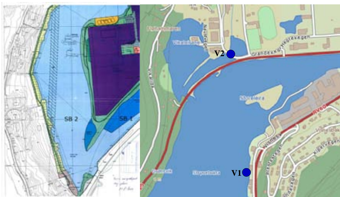
Figur 2. Figur til venstre viser kart over Vikaleire og stasjonene SB1 og SB2 innenfor veifylling. Figur til høyre viser posisjoner for måling av vannstand. Figur kan og brukes for å sammenligne utfylt areal i Vikalera med tidligere grunnområde vist i kart til høyre. Område som ble modellert vises i Figur 3.
