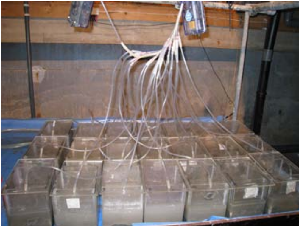
Figur 3. Bilde av forsøksoppsettet som brukt i toksisitetstesten (foto: Sigurd Øxnevad).
