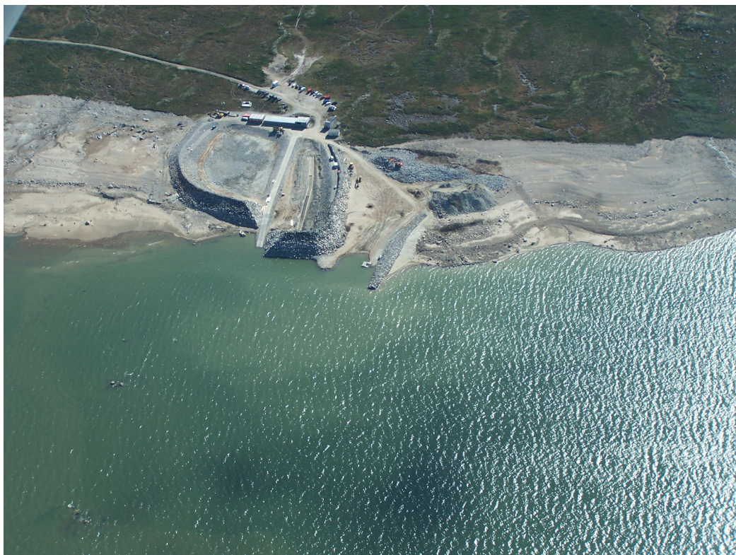
Figur 39. Anleggsarbeider på moloen ved Synken i juni 2009 gjorde at vannstanden ble holdt ved LRV langt utover sommeren. Dette førte til en utvaskning av mye finkorna sedimenter som ga Mår et grønnaktig skjær og førte til svært lavt siktedyp (foto, Sigurd Rognerud)
