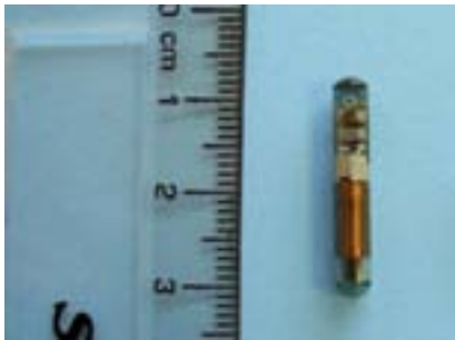
Figur 15. PIT-merkene var 23 mm lang og levert fra Texas Instruments (TIRIS).
