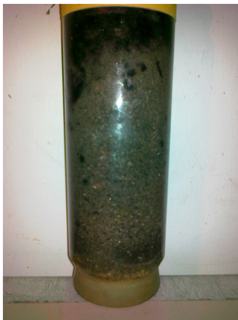
Figur 6. Viser bilde av kjerneprøve 8, som består av ca 17cm sand i bunnen med ett mørkere topplag av nye sedimenter øverst.
