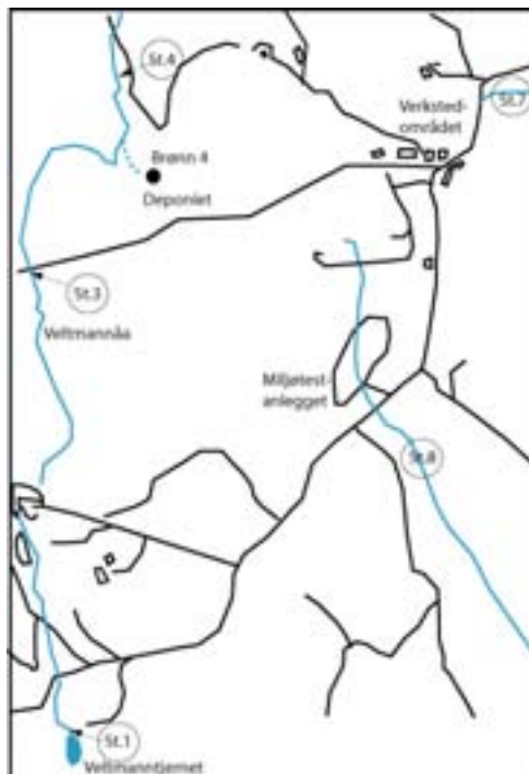
Figur 1. Bradalsmyra testsenter med veinett, bekker og prøvetakningspunktene i Veltmannåa (St.1, 3 og 4), fra verkstedsområdet (st. 7) og miljøtestsenteret (st. 8), samt i grunnvannet nedstrøms deponiet (Brønn 4) som er nærmest Veltmannåa.
