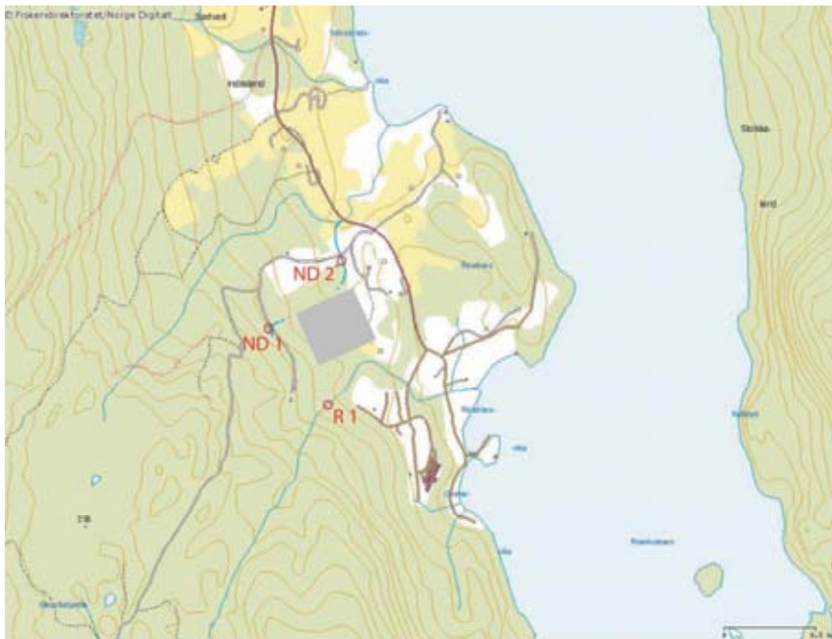
Figur 3. Oversiktskart over undersøkelsesområdet for prøvetaking i ferskvann. Kartet viser situasjonen før utbygging av mottaksanlegget. Opprinnelig var det to flombekker som munnet ut i Grønávika. Nederste del av Rauneselva mottar en sidebekk fra nord - denne er nå lagt i rør og drenerer areal for mellomlagring og oppstilling. Stasjonene som er indikert ligger utenfor mottaksområdet (flere stasjoner er vist på detaljkart i Figur 4 og 5). Området for nytt deponi er grovt indikert som en grå firkant. Bekken som drenerer dette arealet løper sammen med Raunesbekken som munner i Indralandsvika. Kart fra Fiskeridirektoratets karttjeneste ( http://kart.fiskeridir.no/adaptive/ ).
