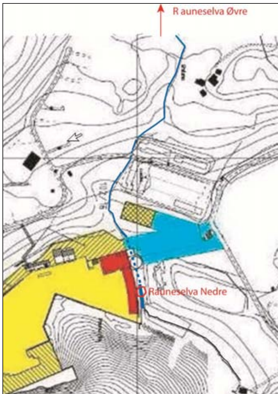
Figur 4. Nedre del av Rauneselva gjennom mottaksanlegget. Nedre stasjon for prøvetaking er vist. Øvre stasjon ligger utenfor mottaksområdet og er vist i Figur 3 . Kartgrunnlaget er fra AF Miljøbase Vats, Områdeinndeling. De gule arealene er arealklasse B (asfalt med membran; skravert gul er asfalt uten membran), og røde arealer er arealklasse A (mest omfattende sikringstiltak mot avrenning av miljøgifter). Arealer farget blått er arealklasse C (uten spesielle rensekrav for avrenning).
