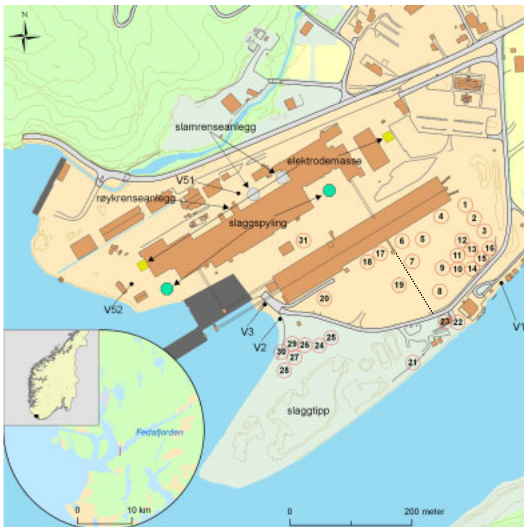
Figur 4. ENK beliggenhet og oversiktskart over tomten med påtegnede kummer/overløp (V1-V52), samt lagerplass som oftest benyttes for oppbevaring av de ulike materialene. Sirkler med nummer 1-30 angir hvilket materiale som blir oppbevart. Beskrivelse av materialene er gjort i Tabell 2 .
