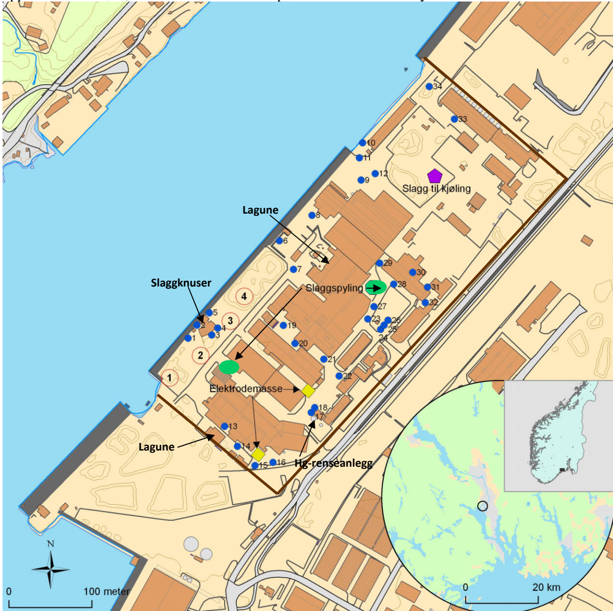
Figur 5. Beliggenhet av ENP i Norge, aktiviteter og oppbevaring av materialer på tomta. ENP-tomtas areal er rammet inn med brune linjer. De blå fylte sirkelene med nummer angir kummer og deres tilhørende ENP-nummer. Sirkler med nummer angir ulike materiale som oppbevares utendørs: 1= omsmelt; 2= kvarts; 3=HC-slagg og 4=koks.
