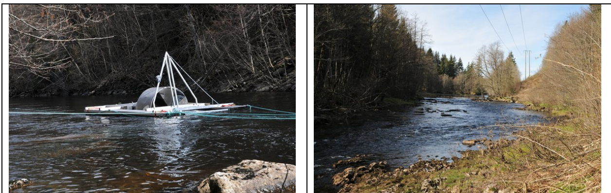
Figur 7. Venstre bilde: Smoltfella oppstrøms kraftverket. Denne hadde en stor fangstrål samt ledegarn mot land. Høyre bilde: Vassdraget oppstrøms fella.
