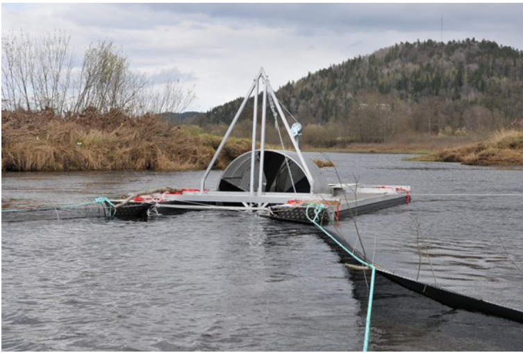
Figur 11. Illustrasjon av smolthjulet ved Butjønna. Smolthjulet var påmontert ledegarn. PIT-antennen var plassert i inngangen til smolthjulet.
