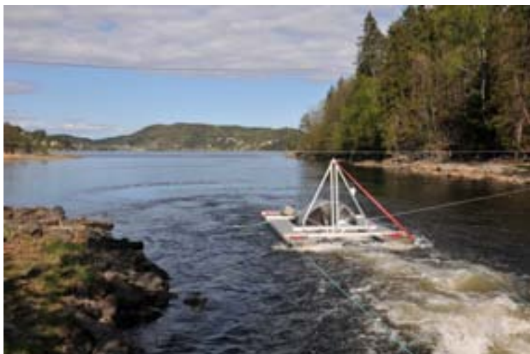
Figur 13. Illustrasjon av smolthjulet ved elveutløpet i Strømmen. Smolthjulet var ikke påmontert ledegarn.
