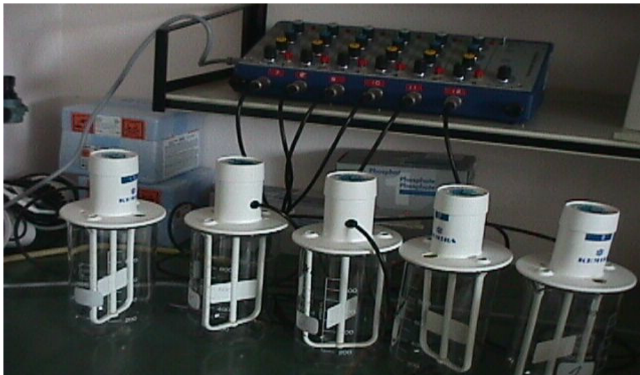
Figur 11. Jar-test apparat med omrørere og begerglass
