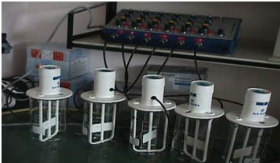
Figur 11. Jar-test apparat med omrørere og begerglass
