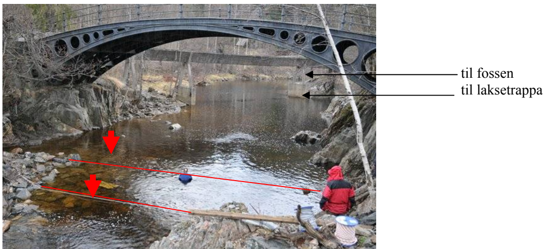
Figur 8. Foto av PIT-stasjon BRU plassert i minstevannføringsløpet. Plassering av hver antenne er antydnet med pil. Bildet viser videre utvandningsrute til laksetrappa eller til fossen Fosstveit.
