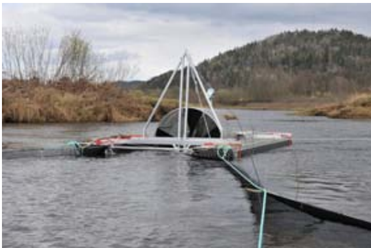
Figur 11. Foto av smoltfelle ved Butjønnå. Smolthjulet var påmontert ledegarn. PIT-antenna var plassert i inngangen til smolthjulet.
