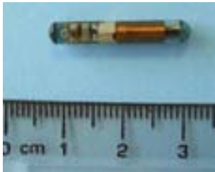
Figur 4. PIT-merkene var 23,1 mm lange og levert fra Texas Instruments (TIRIS).
