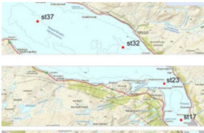
Figur 13. Hydrografiske stasjoner i Repparfjorden med posisjoner og dato for prøvetaking. Ved stasjonene 17 og 23 ble det også plassert ut temperaturlogger på tre dyp (1 m, 4 m og bunn).
