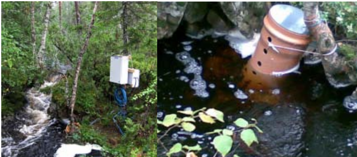
Figur 2. Målestasjon ved bekkens utløp. All elektronikk er montert i vanntette skap som har strømforsyning fra solcelle.
