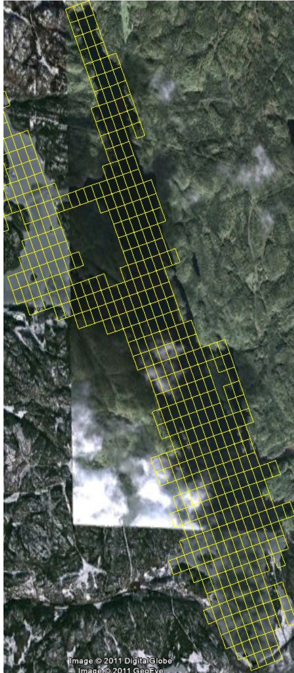
Figur 4. Innsjøen ble delt inn i beregningsceller. I horisontalplanet var disse 100 x 200 meter og vertikalt 1 meter.
